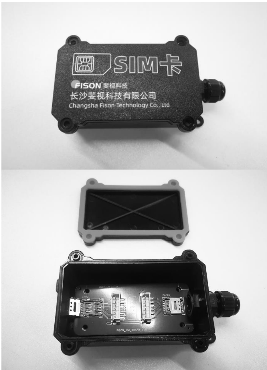
图 1-9 拧开螺丝，打开 SIM 卡盒盖
